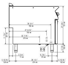
Scarico acqua ΕI Connessione elettrica EQ Vite Equipotenziale
